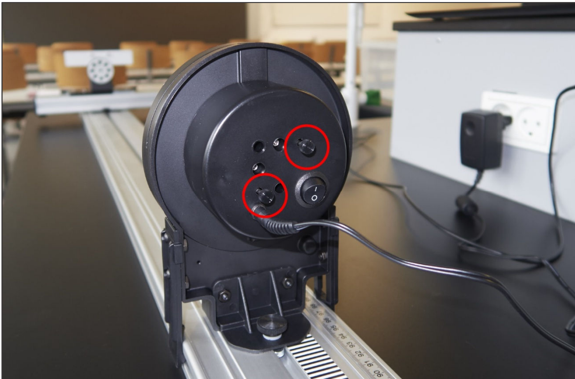
Figur 3. Man skruer på finjusteringsskruerne indtil laserstrålen rammer midt ind på den øverste cirkel på lyssensor-apparatet.
