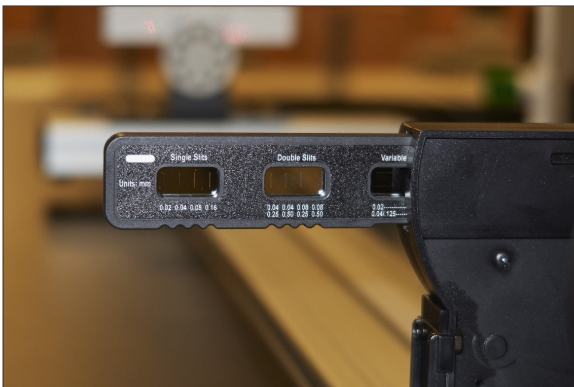
Figur 5. På skyderen sidder en række forskellige enkeltspalter, dobbeltspalter, multiple spalter, etc.
